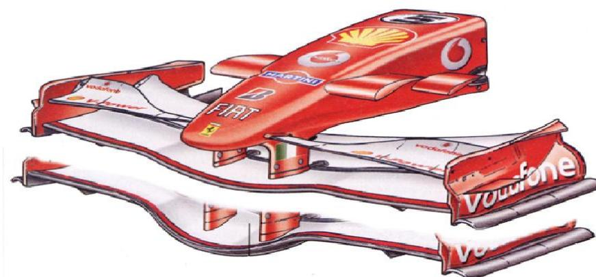
**法拉利248f1前翼** 法拉利在蒙扎保留了比雷诺更多的前部空气动力学部件，其中前翼主板近乎平直，中间只有轻微的勺状痕迹(下方的为土耳其站使用的版本)。在鼻锥上新增的小翼于将赛车前部的下压力向后转移。 ©/dando piron 2/11/13
