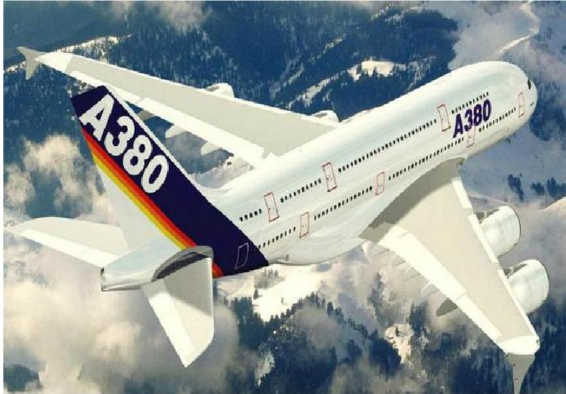
这是空客 A380 的飞机参数，长度 73 米，翼展 79.8 米，高度 24.1 米，机翼面积  $845 \text{ 米}^2$ ，空机重量 280 吨，最大起飞重量 560 吨。看看，这么一个巨无霸，怎么能像鸟一样在天空自由飞翔呢？
