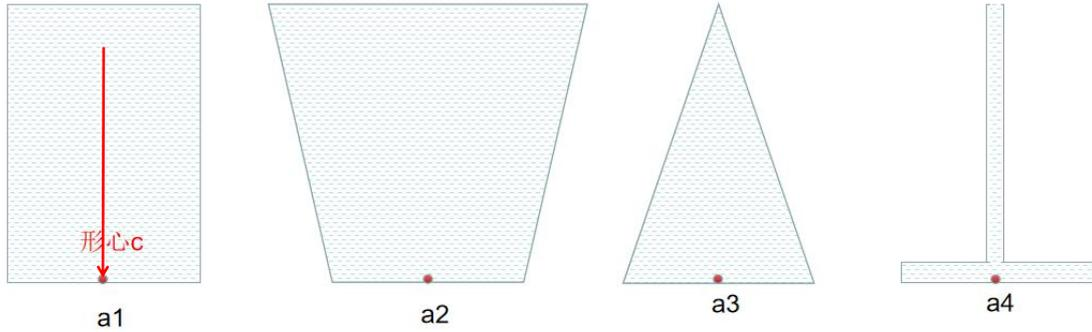
a1, a2, a3, a4 四个容器装满了水，水的密度是  $1000\text{kg/m}^3$ ，底面积都是 1 平方米，液面高都是 1 米，液面是大气压。请注意，液面为大气压的面也叫自由面。大家先看看哪个容器受的压力最小啊，压力多大？
